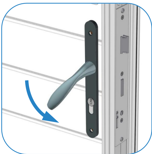
Actionner et maintenir la poignée vers le bas
