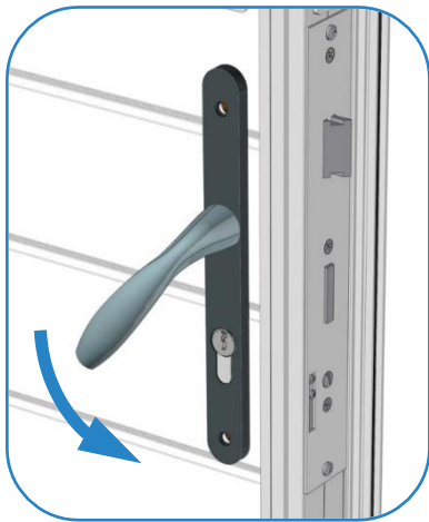
1 Actionner et maintenir la poignée vers le bas
