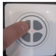
Relâcher le bouton « montée » de la commande générale.
