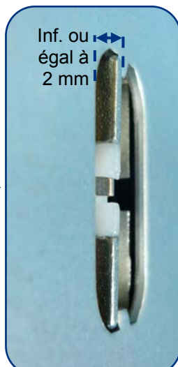
Les pènes peuvent sortir inférieur ou égal à 2 mm
