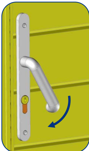
Actionner et maintenir la poignée vers le bas
